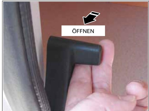
Abb. 12 Zweiten Flügel der Zweiflügel-Hecktür von innen öffnen und schließen
