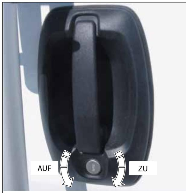
Abb. 10 Ersten Flügel der Zweiflügel-Hecktür von außen öffnen und schließen
