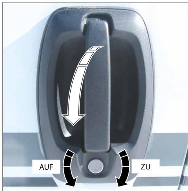
Abb. 6 Fahrer- und Beifahrertür von außen öffnen und schließen
